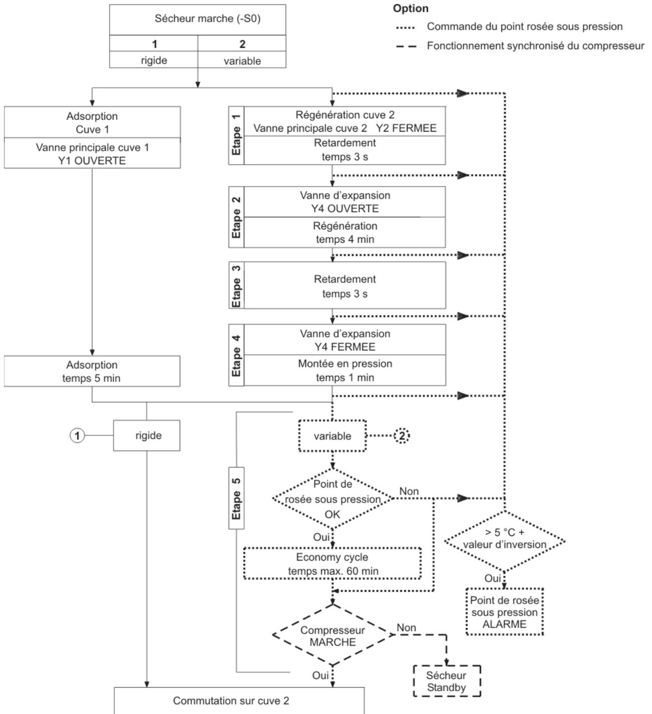
Régénération dans B1 et adsorption dans B2
